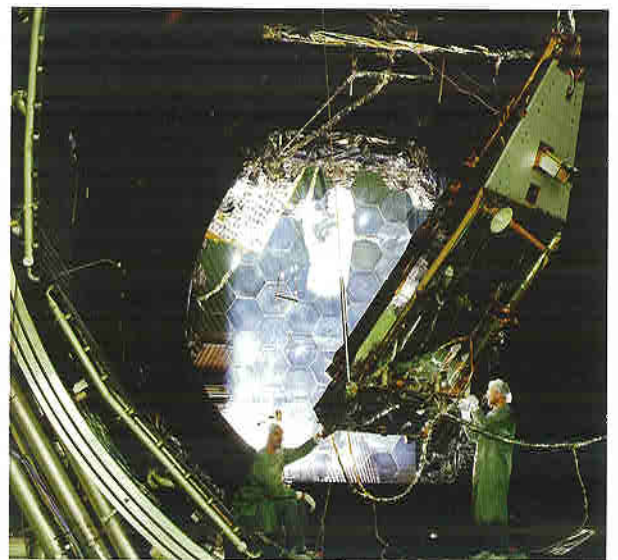
Der Satellit CHAMP bei Tests. Die Lampen simulieren das Sonnenlicht im Weltraum. (Foto: Astrium).
